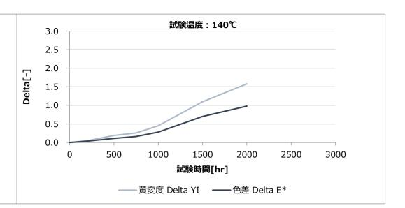
試験条件 材料:301-15 測定厚み:2mm
